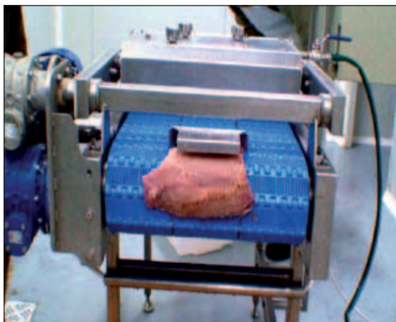
Fot. 4. Ponacinany płat karpia opuszczający maszynę
